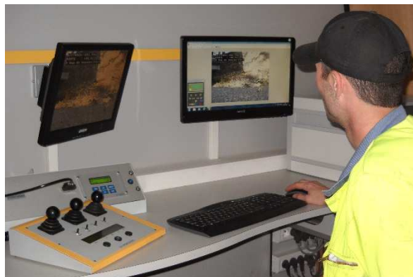
Exemple d'inspection télévisée avec véhicule spécialisé
