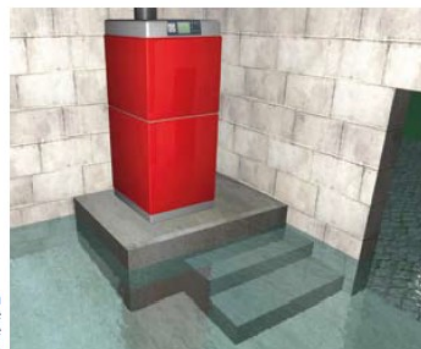
Protection d'un équipement de chauffage par surélévation.
