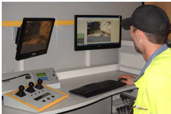
Exemple d'inspection télévisée avec véhicule spécialisé
